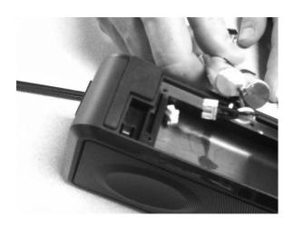
7. UNPLUG HOUSING CONNECTOR FROM BATTERY CONNECTOR
